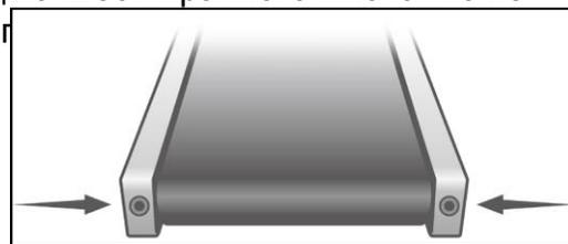
**НЕ ПЕРЕТЯГИВАЙТЕ** – Слишком сильное затягивание болтов может вызвать повреждение бегового полотна и преждевременный отказ подшипника. Если Вы уже достаточно натянули полотно, а оно все еще проскальзывает, проблема может быть в приводном ремне, который расположен под крышкой двигателя и соединяет двигатель с передним роликом. Если этот ремень ослаблен, это легко спутать с плохо натянутым беговым полотном. Натяжение приводного ремня должно производиться только квалифицированным персоналом.
