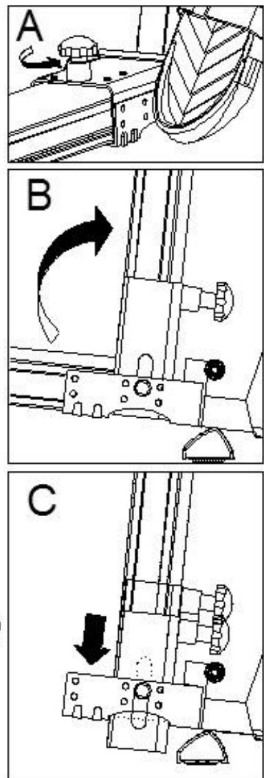
Ослабьте гайку, потяните направляющую каретки и затем, можете поднять её вверх и зафиксировать, надавив на неё сверху вниз.
